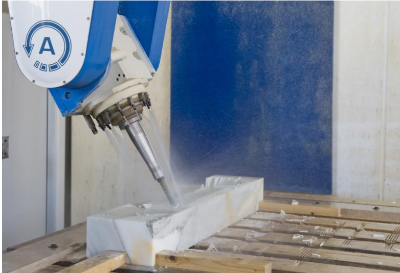
Bild 1: „Maschinelle Bearbeitung von Marmor mit Wasserstrahltechnik“
