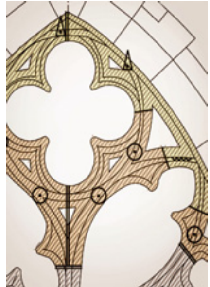
Die Steinmetzwerkstatt Kling hat die Maßwerkfenster im Joch 5/20 konservatorisch restauriert, hier Joch 20, Vor- und Endzustand. Unter Berücksichtigung der Vorgabe, die Originalsubstanz maximal zu erhalten, arbeiteten Ulrich Kling und sein Team bei großen Schadensbereichen halbe Neuteile nach historischem Vorbild, die sie auf die intakte Konstruktion aufdoppelten und verankerten. Hierfür erhält er bei der Peter Parler-Preisverleihung eine Belobigung. Bilder: Firma
